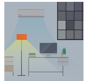
Detekcja nastonecznienia Funkcja dostosowuje moc chłodzenia odpowiednio do zmian nastonecznienia.
